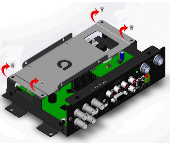
**4** Устанавливаем жесткий диск на стойку, так чтобы сторона с разъемами была повернута к специальному отверстию для проводов на стойке.
